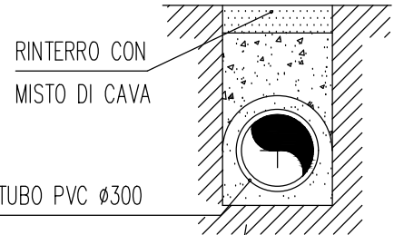
PATICOLARE SEZIONE TUBO PVC
